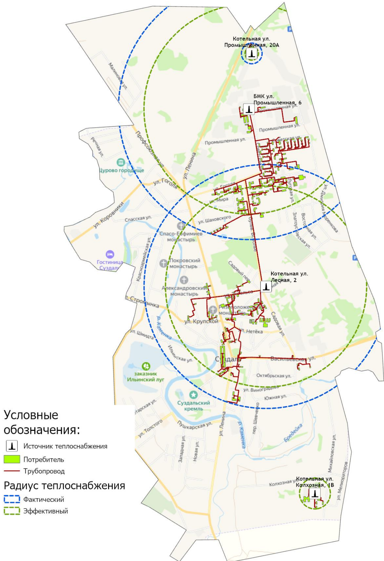
Рисунок 2.5.1 - Радиусы эффективного теплоснабжения котельных г. Суздаль
